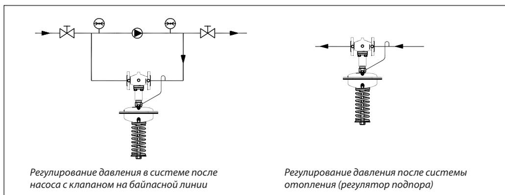
Регулирование давления в системе после насоса с клапаном на байпасной линии
