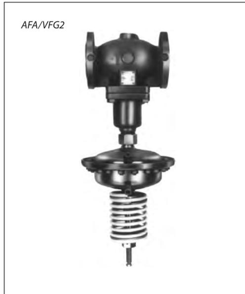
AFA/VFG2 — автоматический регулятор, поддерживающий постоянное давление в трубопроводе до регулятора (по ходу движения теплоносителя). Предназначен для применения в системах централизованного теплоснабжения. При повышении давления до регулятора клапан открывается.
